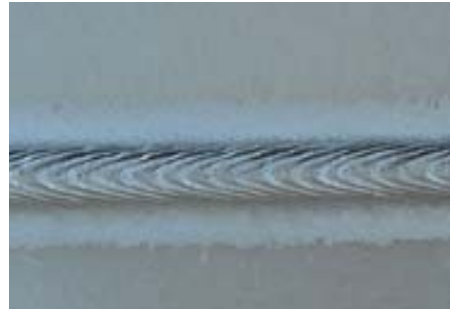
Soldadura en angulo sobre chapa de un mm AlMg3 con velocidad de soldadura de 2m/min.
