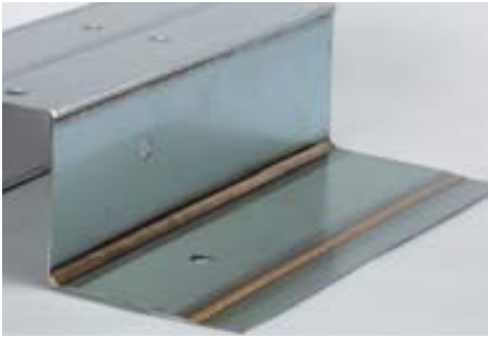
CMT brazing entre chapas galvanizadas electrolíticamente y en caliente. Espesor de la chapa 1.0 mm. Hilo de aporte CuSi3.
