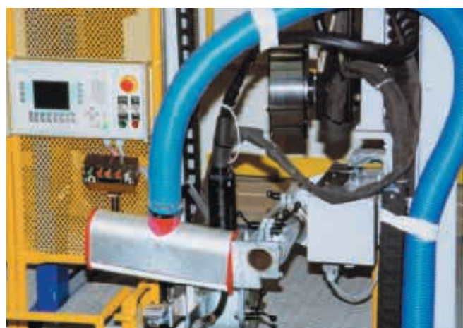
Panel de control y cabeza de soldadura (con antorcha, cabeza láser, dispositivo de aspiración de gas de humo)
