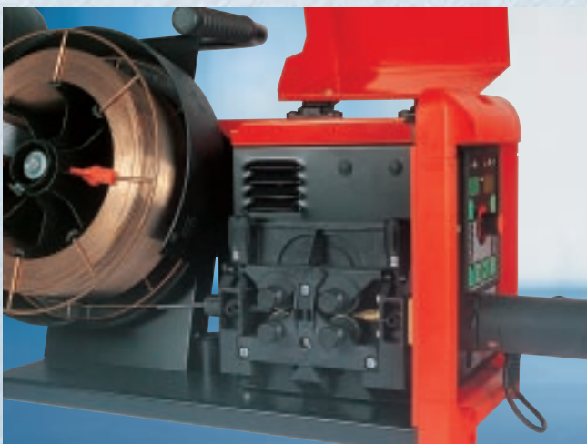
Accionamiento a 4 rodillos para un transporte de hilo preciso y exento de fallos.
