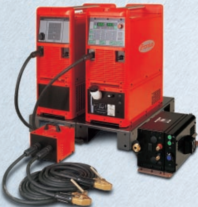
El TPS 9000 que alcanza un rendimiento de hasta 900 A fue concebido para la soldadura automatizada y robotizada.
