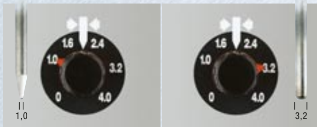
Formación automática de calota aplicable desde la tecla de soplete
