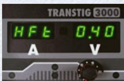
Frecuencia de repetición de ignición ajustable sin escalonamientos
